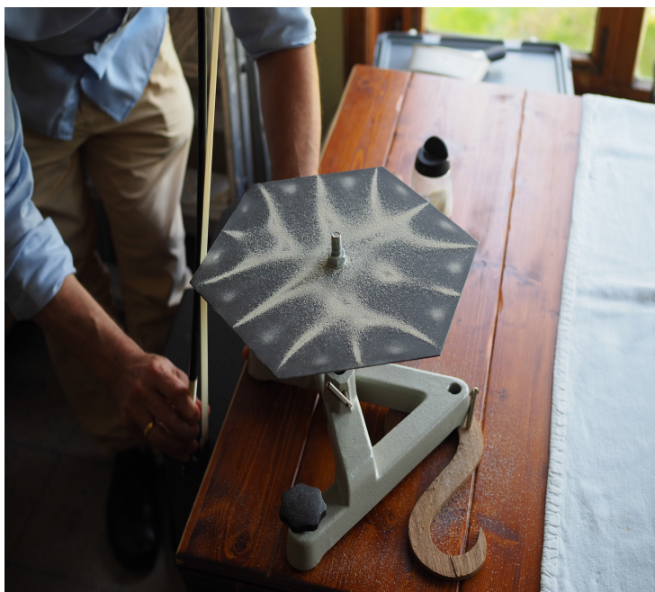
Generieren einer kymatischen Klangfigur mit Weizengrieß
