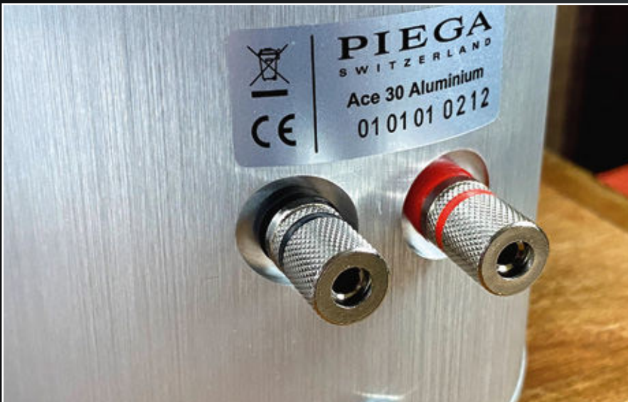
Zwei Multi-Connectors für Lautsprecher- bzw. Bananenstecker und eine Bassreflexöffnung für tiefere Frequenzen. Simpel und effektiv
